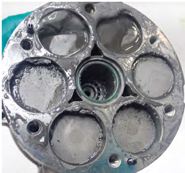
Abb. 1 Starker Fresser an Kolben und Zylinder
