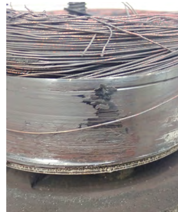
Abb. 1 Schleifspuren am Spulenkörper und Spule verbrannt
