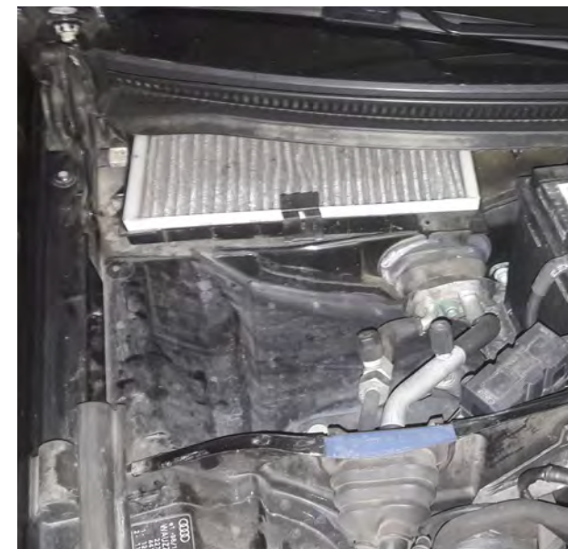
Abb. 1 Stark verschmutzter Innenraumfilter
