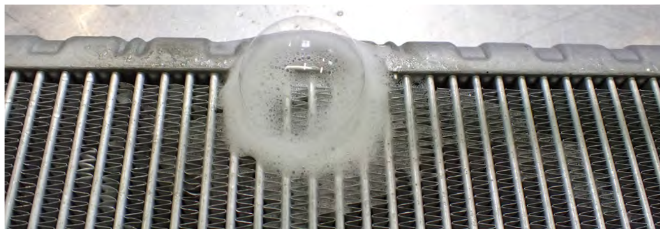
Abb. 3 Verdampfer undicht
