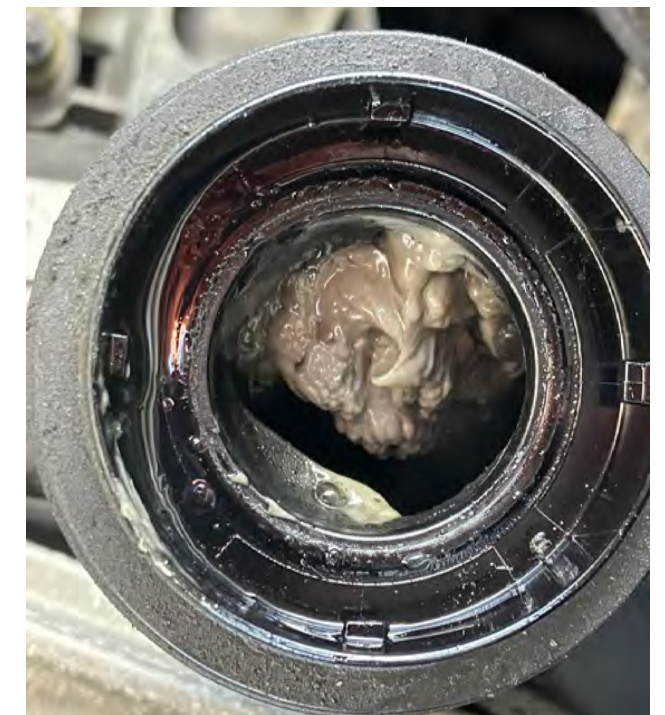
Abb. 3 Öl-Wasser-Emulsion am Öleinfüllstutzen
