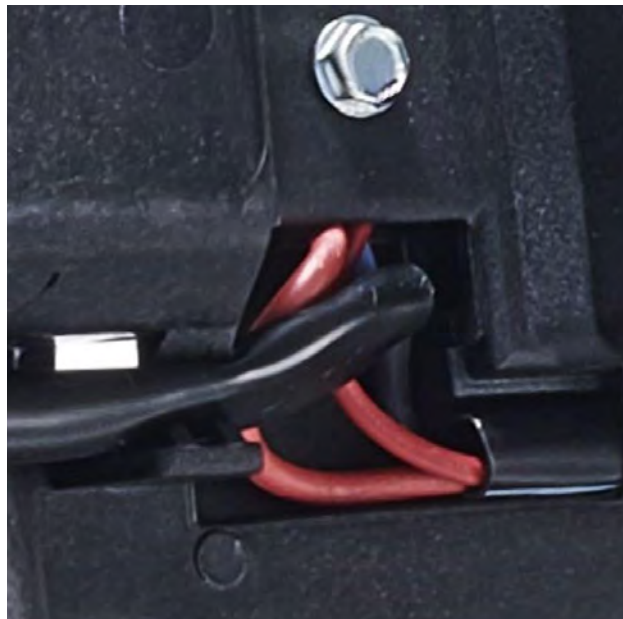
Abb. 2 Kabelbruch an Lüftersteuerung
