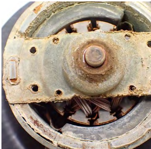
Abb. 1 Lagerschaden am Lüftermotor
