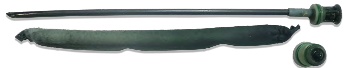
Abb. 3 Filter-Trockner zugesetzt
