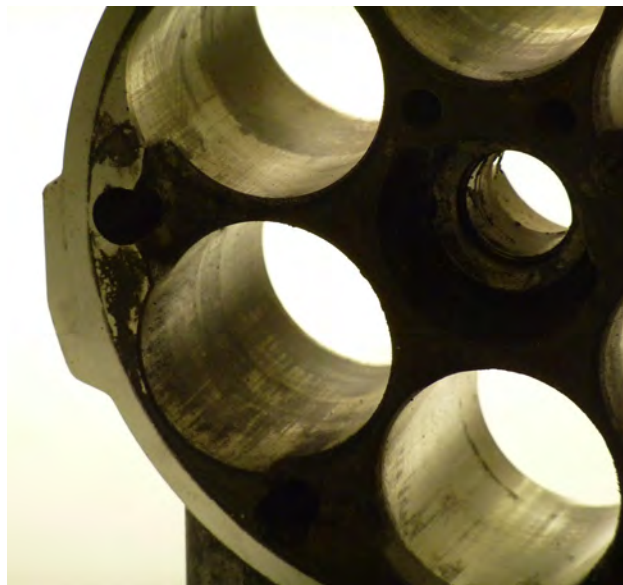
Abb. 2 Fresser am Zylinder
