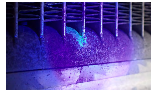
Abb. 2 Durchrostung am Kondensator
