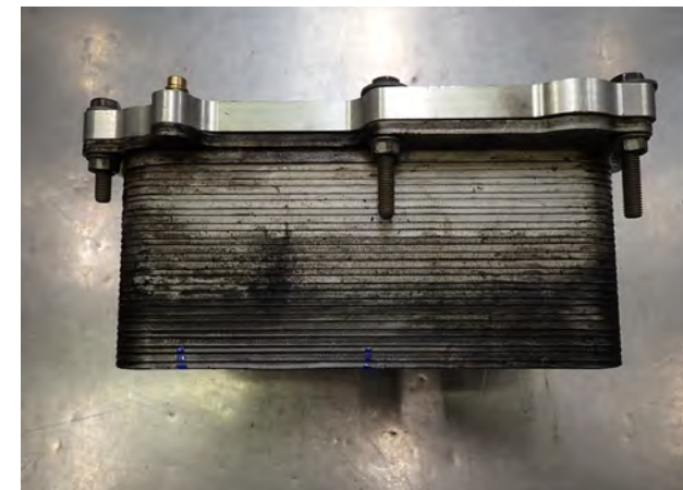
Abb. 1 Undichter Ölkühler
