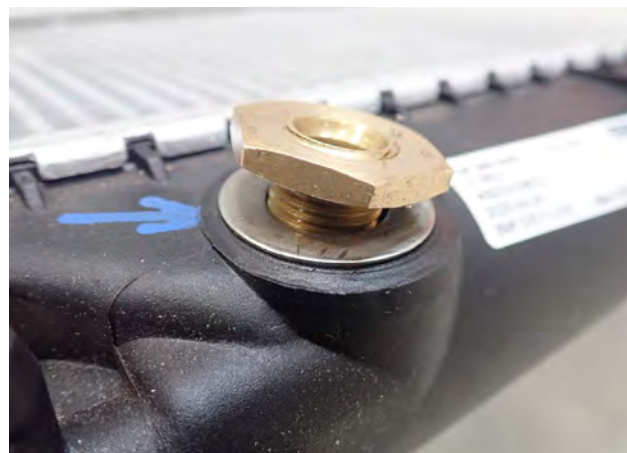
Abb. 3 Schraubanschluss Getriebeölleitung
