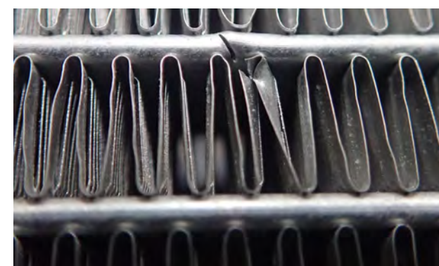
Abb. 3 Mechanische Beschädigung (Schnitt)
