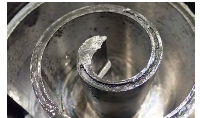
Abb. 2 Stirnseitige Dichtung an Spirale zerstört
