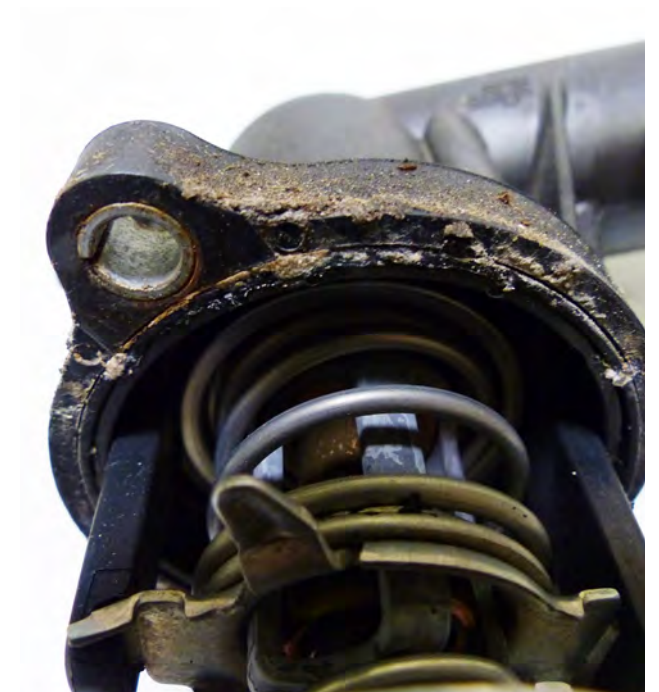
Abb. 2 Dichtung durch zusätzliche Dichtmasse geschädigt
