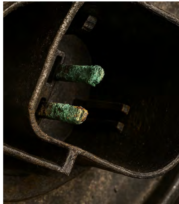
Abb. 2 Korrosion an Steckverbindung
