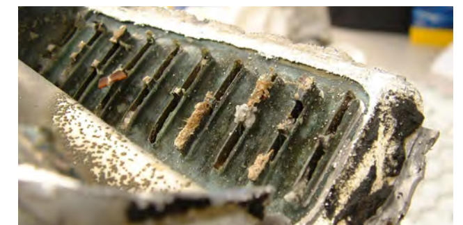
Abb. 2 Kühler durch Dichtmittel blockiert
