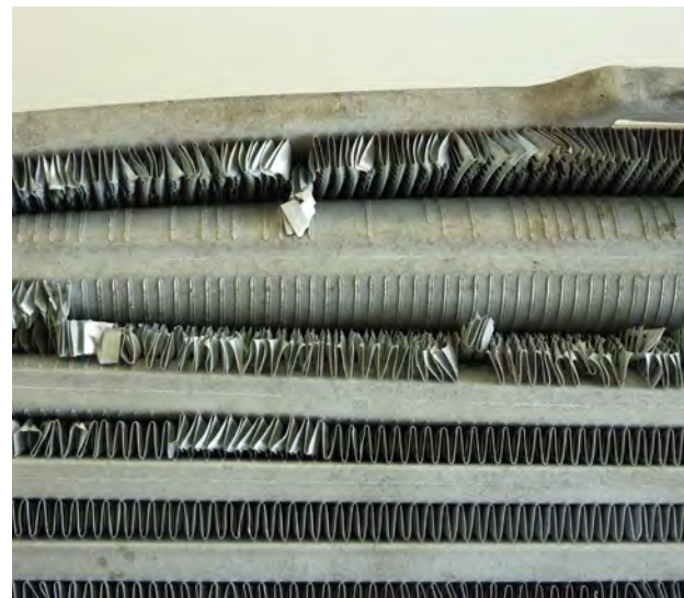
Abb. 3 Kühlerrohr aufgebläht
