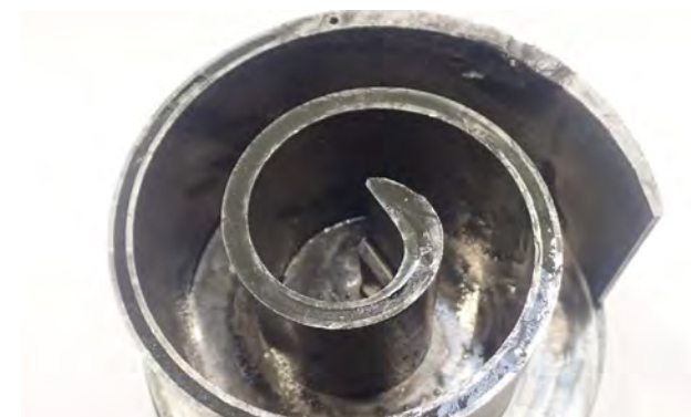
Abb. 1 Spirale vom Scroll-Kompressor stark abgenutzt
