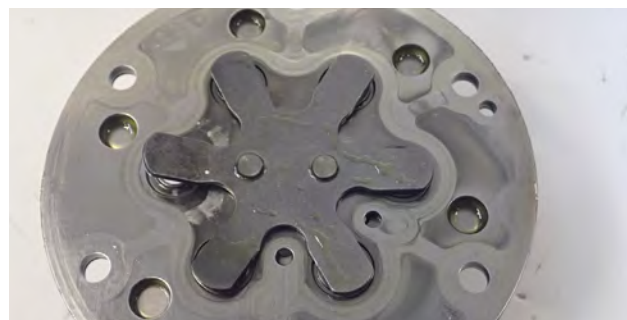
Abb. 2 Begrenzung von HD-Ventil deformiert
