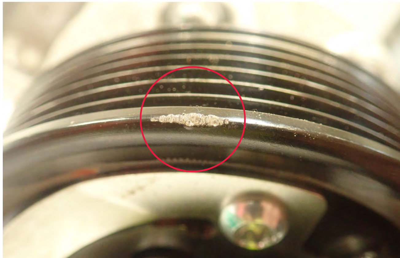
Abb. 1 Riemenscheibe beschädigt
