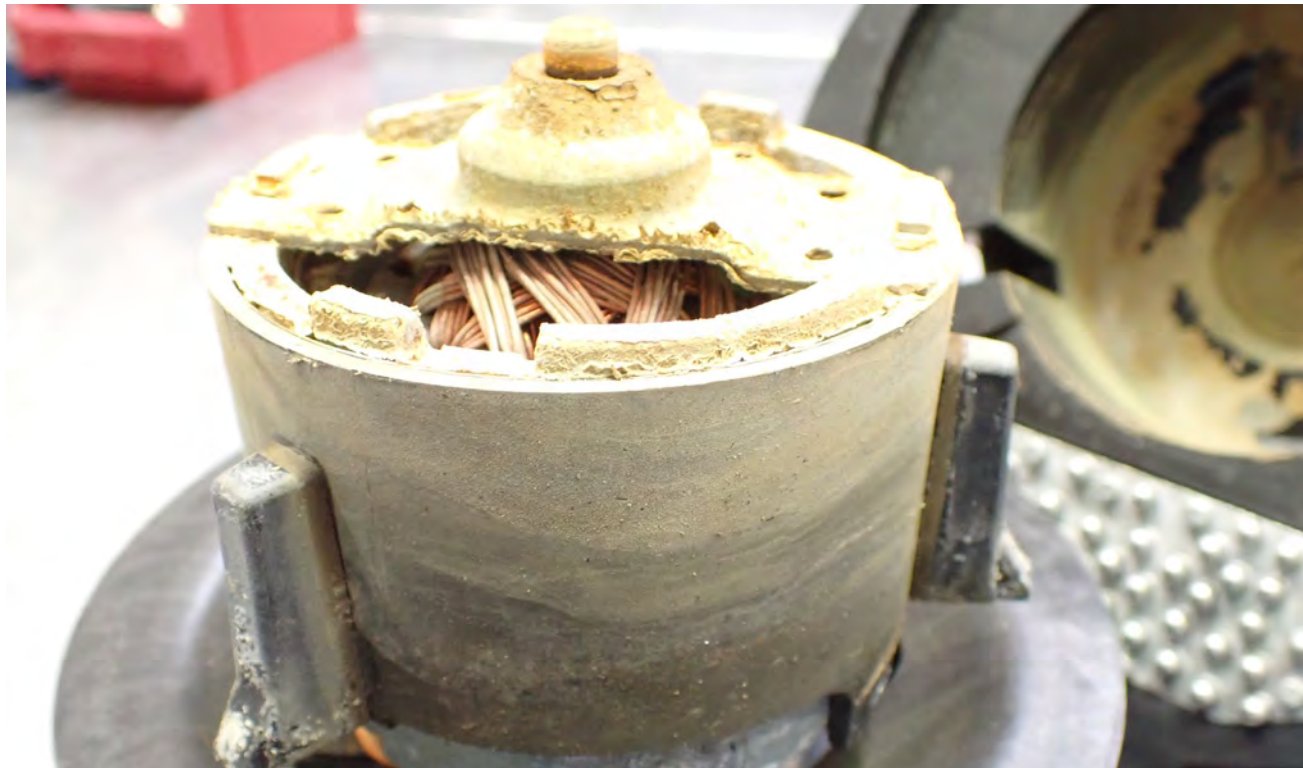
Abb. 4 Korrosion am Gebläsemotor
