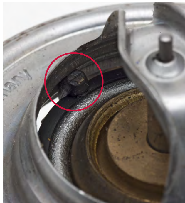
Abb. 1 Fremdkörper blockiert das Ventil
