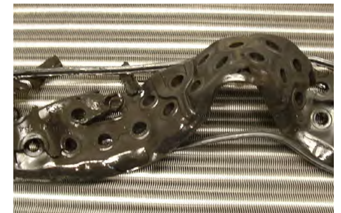
Abb. 1 Aufgequollene Dichtung aus Kühlmittelkühler
