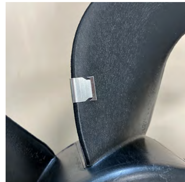
Abb. 1 Metallklammer als Gewicht zum Auswuchten
