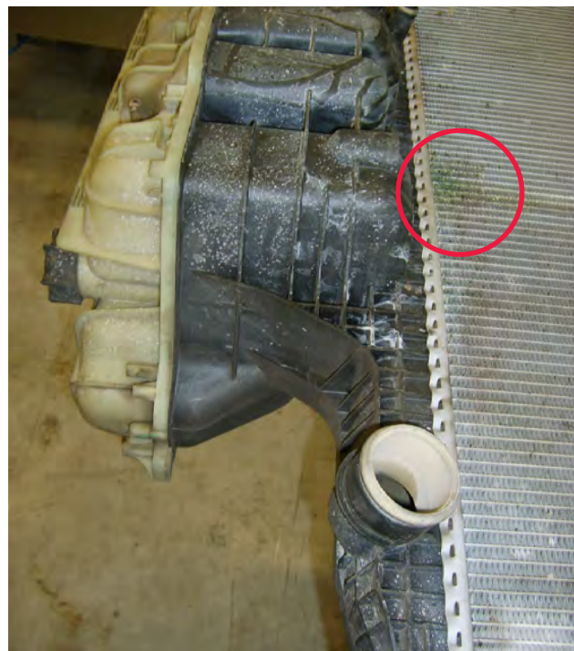
Abb. 1 Kühler scheinbar undicht
