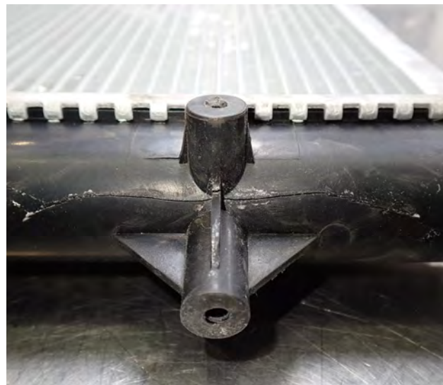
Abb. 2 Geplatzter Wasserkasten
