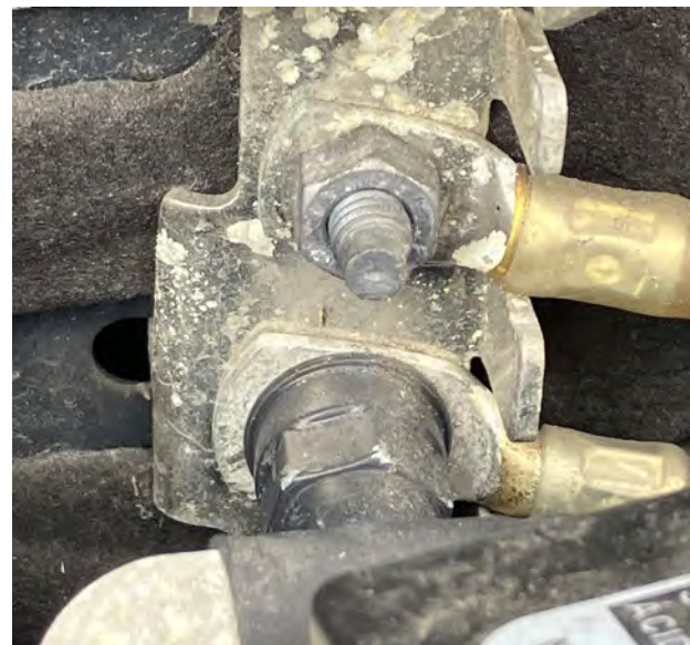
Abb. 2 Korrosion am Massepunkt
