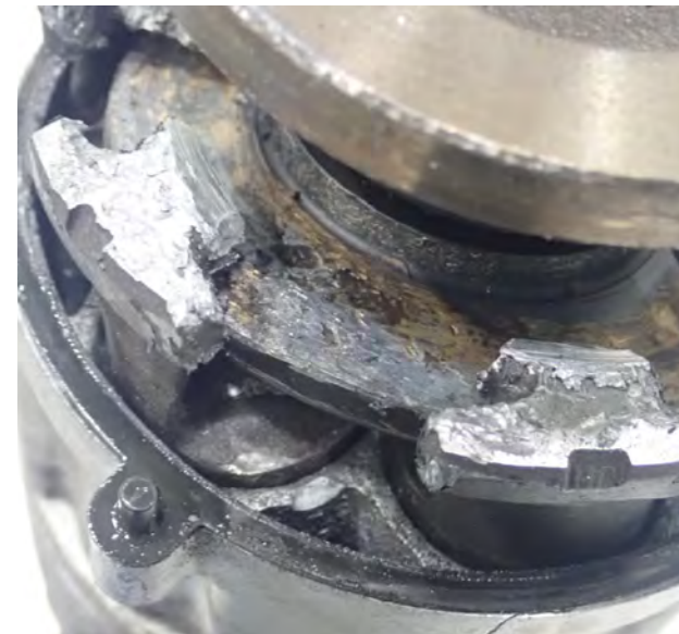
Abb. 3 Fresser an Kolben und Taumelscheibe
