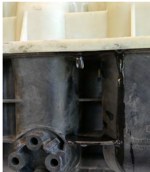
Abb. 2 Kühlmittel tropft aus Ausgleichsbehälter
