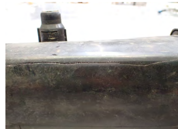
Abb. 1 Riss im Ausgleichsbehälter
