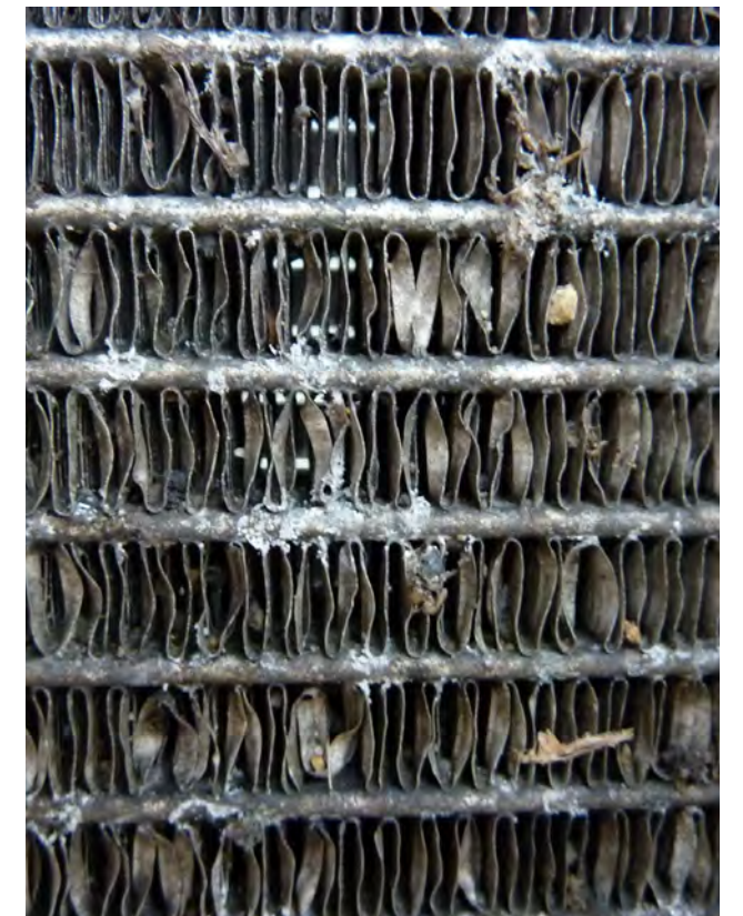
Abb. 2 Verunreinigungen und deformierte Kühllamellen
