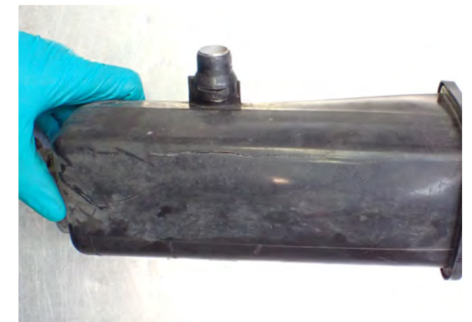
Abb. 2 Geplatzter Ausgleichsbehälter
