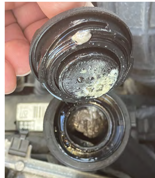
Abb. 2 Öl-Wasser-Emulsion am Öleinfülldeckel und Öleinfüllstutzen
