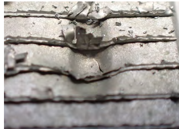
Abb. 2 Deformation und Riss
