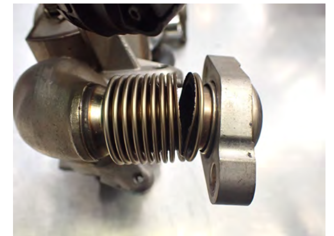
Abb. 2 Flexrohr von AGR-Kühler angerissen
