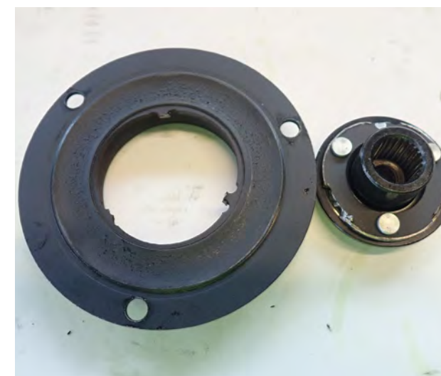
Abb. 1 Überlastsicherung gebrochen
