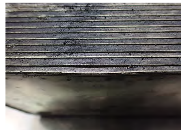
Abb. 2 Undichter Ölkühler
