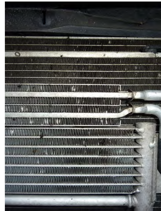
Abb. 1 Verunreinigung am Kühler
