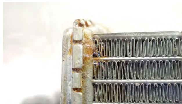
Abb. 4 Durchgerosteter Wärmetauscher
