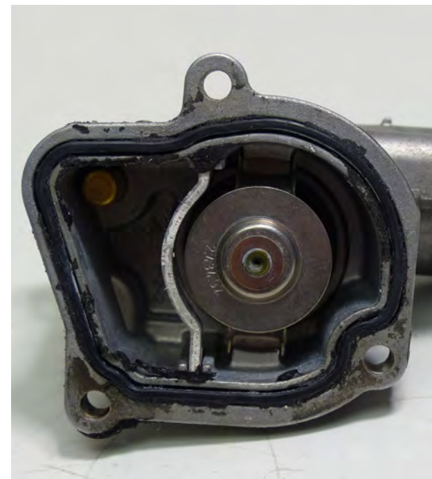
Abb. 1 Dichtmasse an Thermostatgehäuse
