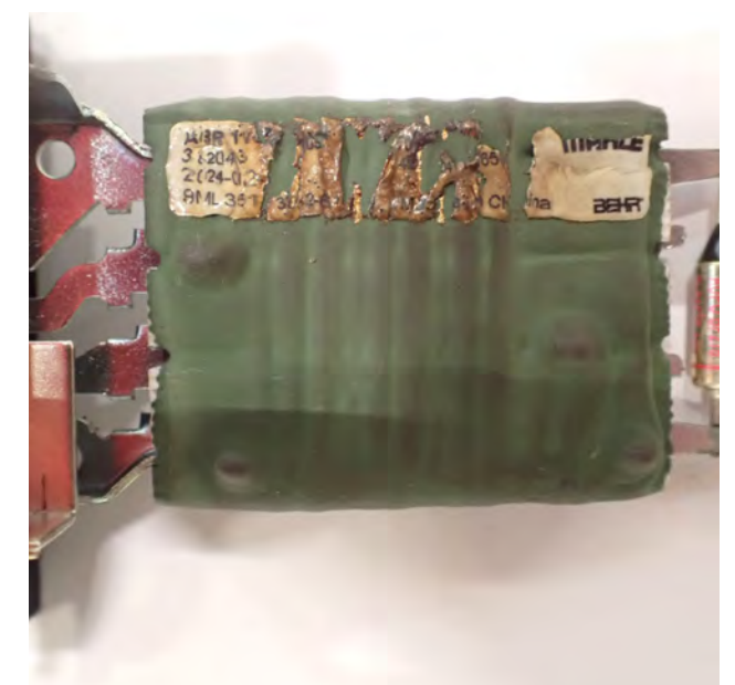
Abb. 2 Gebläse Regler thermisch überlastet
