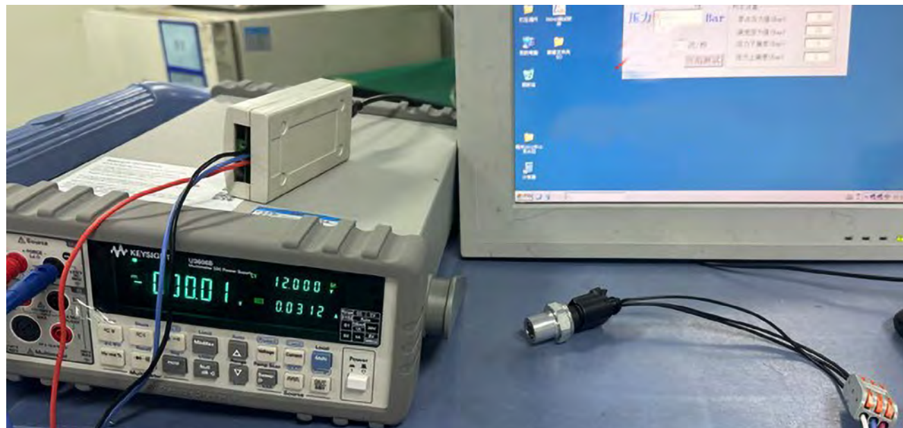
Abb. 4 Prüfung eines Druckschalters im Labor
