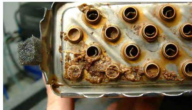
Abb. 2 Zugesetzter Wärmetauscher
