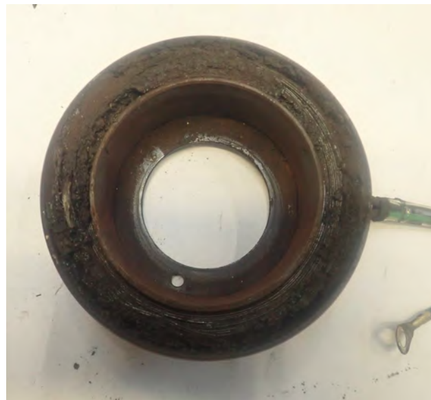
Abb. 1 Magnetspule durch rutschende Kupplung verschmort
