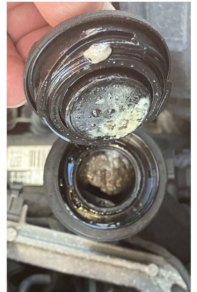
Abb. 3 Öl-Wasser-Emulsion an Öleinfüllstutzen
