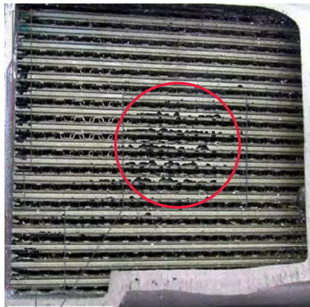
Abb. 1 Kavitation an den Rohren des Ölkühlers
