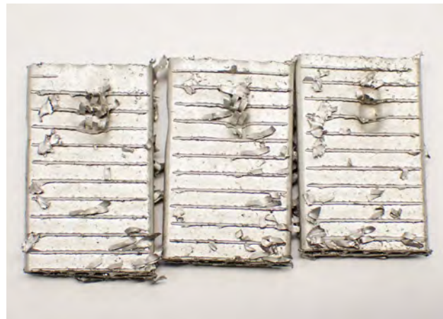
Abb. 1 Deformation der Rohre von außen nach innen
