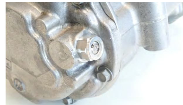
Abb. 1 Überdruckventil hat ausgelöst
